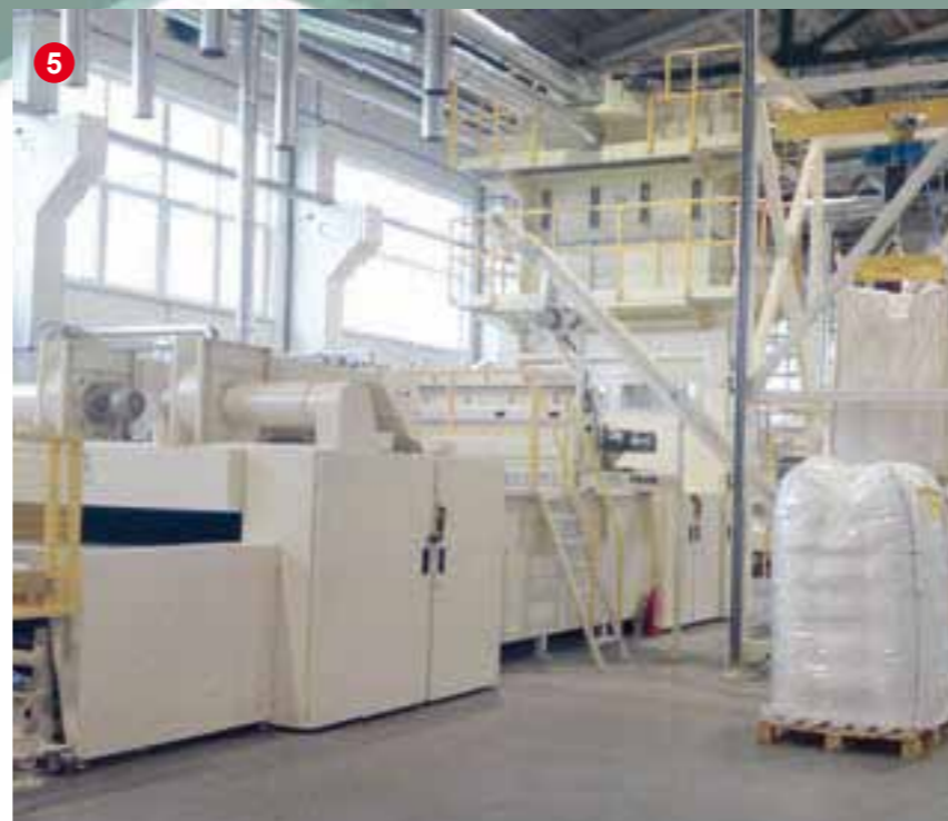
NAPADORA NEUMÁTICA "FELTECH" CON APLICADOR DE RESINA
