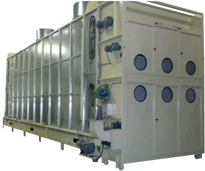
ABRIDORA FINA MODELO AC CON CARGADOR VERTICAL Y CONDENSADOR MODELO CO
